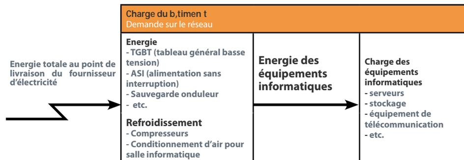
$$PUE = \frac{\text{Energie totale au point de livraison}}{\text{Energie des équipements informatiques}} \quad DCiE = \frac{1}{PUE} = \frac{\text{Energie des équipements informatiques}}{\text{Energie totale au point de livraison}}$$
